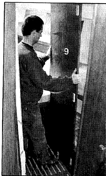
9 - Démonter la cloison latérale avant. Cette cloison est sur charnière et se plie en deux. La mettre de côté.
